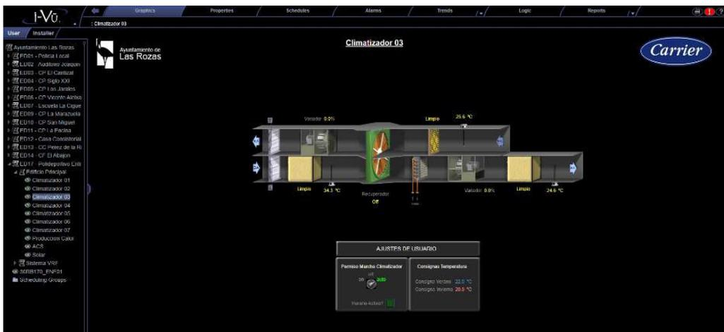
**Imagen 3: Ejemplo SCADA Unidad de Tratamiento de Aire**
