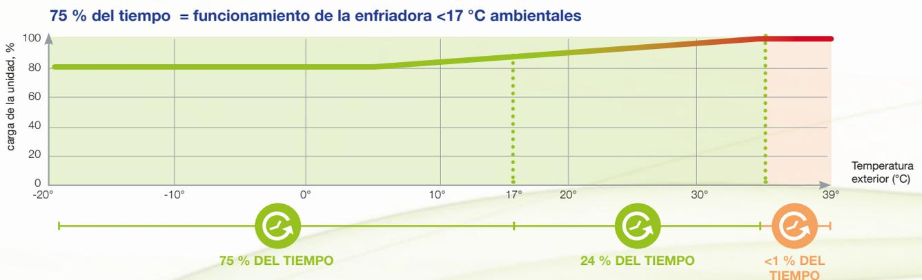
El SEPR es una nueva forma de medir la eficiencia energética real de las enfriadoras para la refrigeración de procesos a lo largo de un año completo.
