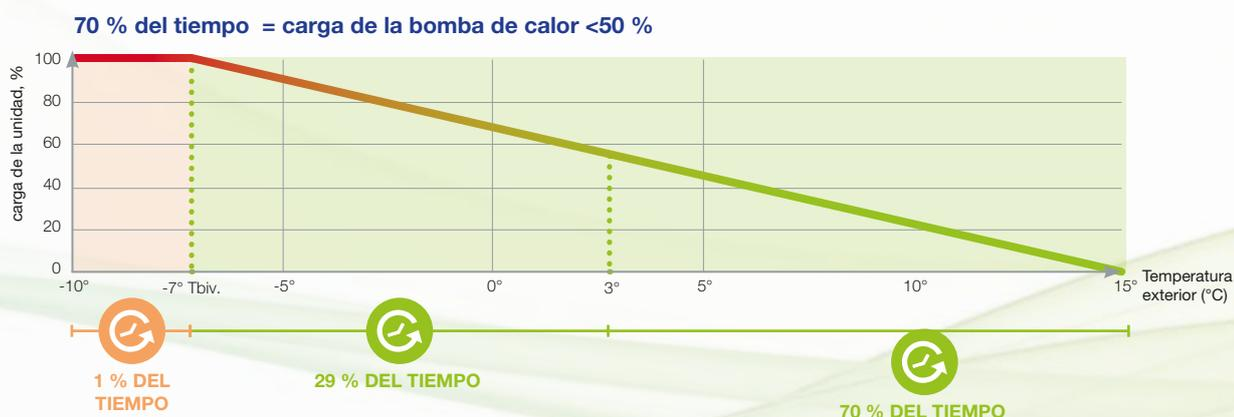
El SCOP es una nueva forma de medir la eficiencia energética real de las bombas de calor a lo largo de un año completo. Este nuevo ratio consigue una indicación más realista de la eficiencia energética real y el impacto medioambiental del sistema de calefacción. El valor alcanzado por el SCOP está directamente relacionado con su correspondiente valor  $\eta_{s, calor}$ .
