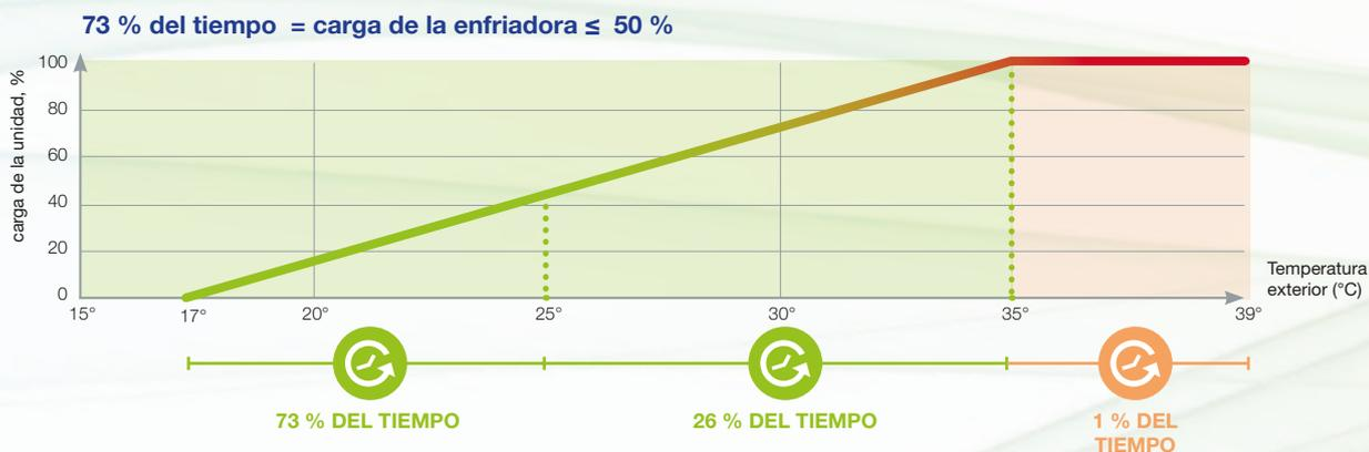
**El SEER es una nueva forma de medir la eficiencia energética real de las enfriadoras para la refrigeración con fines de confort a lo largo de un año completo.**
