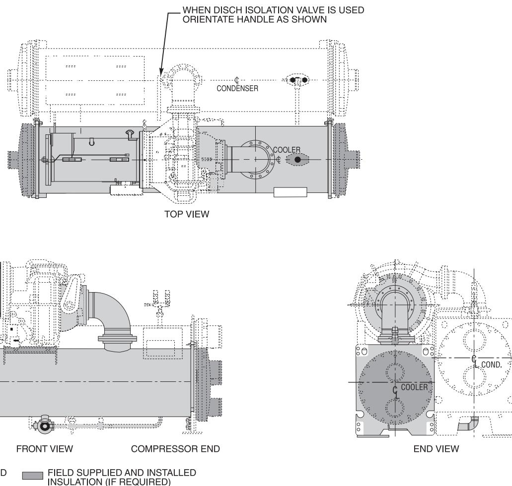
**19XR,XRV FACTORY-INSTALLED INSULATION AREA (cont)**
